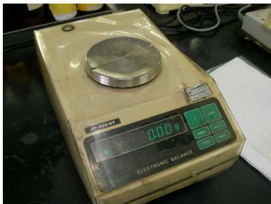
最大1/1000g計測できる微細な重量計を用いる
